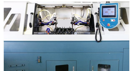
Автоматическая и одновременная резка с помощью двух шпинделей
